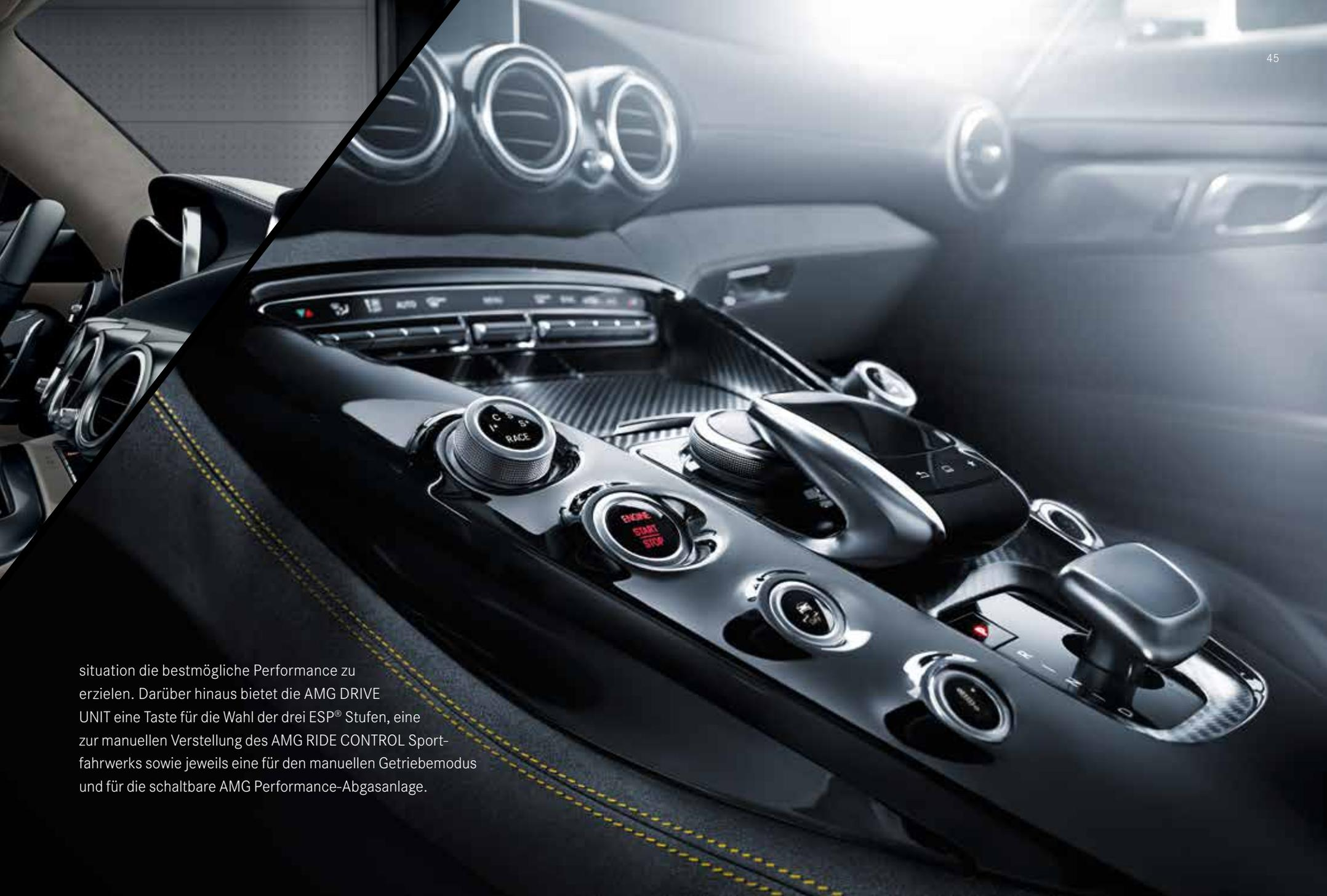
situation die bestmögliche Performance zu erzielen. Darüber hinaus bietet die AMG DRIVE UNIT eine Taste für die Wahl der drei ESP® Stufen, eine zur manuellen Verstellung des AMG RIDE CONTROL Sportfahrwerks sowie jeweils eine für den manuellen Getriebemodus und für die schaltbare AMG Performance-Abgasanlage.
