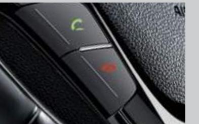
**Управление hands-free на рулевом колесе** Клавиши управления телефонной связью через Bluetooth удобно расположены на рулевом колесе. Они позволяют вам принимать звонки и звонить самому, не отвлекаясь от управления автомобилем.
