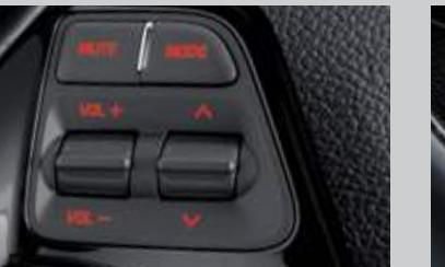
**Управление аудиосистемой на рулевом колесе** Удобные органы управления, вынесенные на руль, позволяют управлять аудиосистемой, не снимая рук с рулевого колеса.
